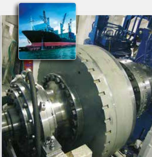
Des moteurs, les boîtes de vitesse et les arbres porte-hélices de bateaux sont alignés avec le système Easy-Laser®. Grâce aux supports adaptables vous pouvez placer l'équipement à l'endroit le plus approprié ; axe, accouplement ou volant.
