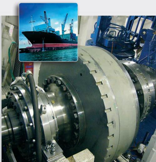
Двигатель, редуктор и гребной вал на судах центруют с помощью системы Easy-Laser®. Благодаря набору кронштейнов Вы можете устанавливать датчики в наиболее удобных местах: на валу, на муфте или на маховике.
