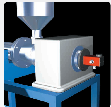
Lasersender auf der Getriebspindel.
