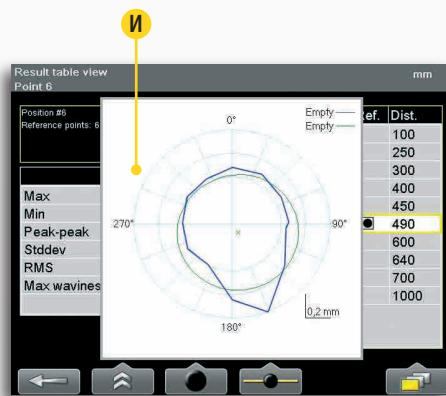
Благодаря методу многоточечного измерения можно легко определить возможную овальность отверстий (И).
