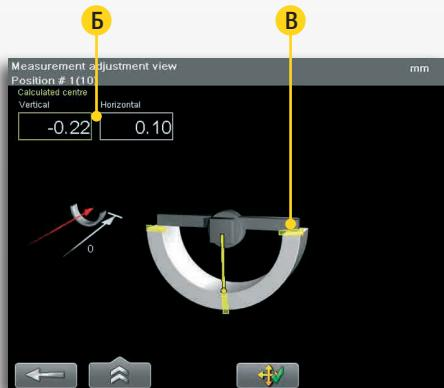
3. Регулировка положения объекта измерения по непосредственным значениям. Отображение значений параметров объекта по вертикали и по горизонтали (Б). Отметками на окружности обозначена зона регулировки положения по непосредственным значениям (В).
