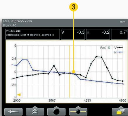
Результат отображается как «Наилучшее расположение вокруг 0°» (3) с точным графиком.
