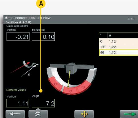
2. На изображении показано направление детектора. Отметкой на окружности показана активная точка измерения. Указано значение измерения и угловое положение детектора (A).
