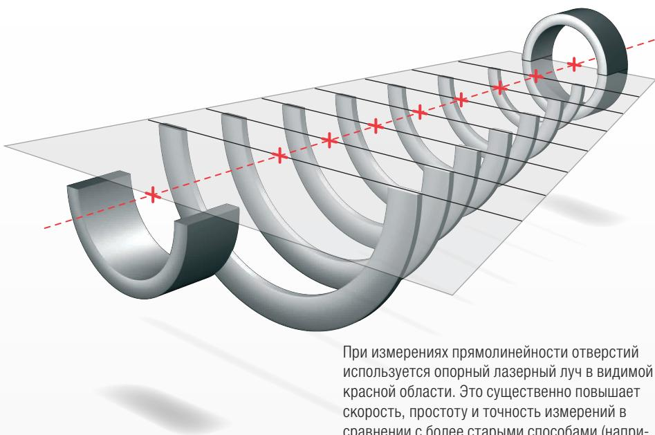
При измерениях прямолинейности отверстий используется опорный лазерный луч в видимой красной области. Это существенно повышает скорость, простоту и точность измерений в сравнении с более старыми способами (например, с помощью струнной проволоки).
