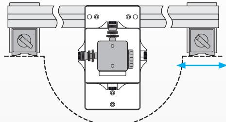
Благодаря регулируемым магнитным основаниям и лазерному излучателю установка кронштейна выполняется очень быстро.
