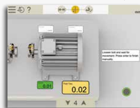
Comprobación del desajuste de las patas
