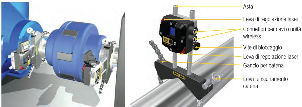
Unità di misurazione montate
