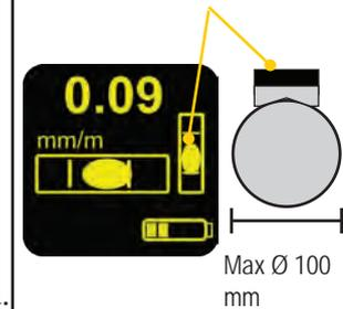
L'impiego del livello di precisione per la misurazione dell'albero è consigliato solo per alberi di diametro non superiore a 100 mm.
