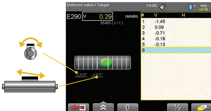
L'impiego del livello di precisione per la misurazione dell'albero è consigliato solo per alberi di diametro non superiore a 100 mm.
