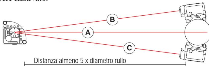
1. Posizionare il trasmettitore laser parallelamente al rullo (A) e metterlo a livello con la livella a bolla. La distanza tra il rullo e il trasmettitore laser deve essere pari ad almeno cinque volte il diametro del rullo.
