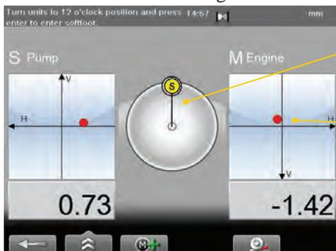
Ruotare le unità di misurazione a ore 12.
