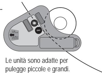
1. Montare il trasmettitore laser sulla macchina stazionaria.
