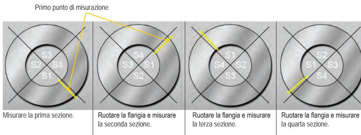
È possibile misurare da 1 a 5 cerchi di punti di misurazione, ad esempio i cerchi interno, centrale ed esterno, per vedere la rastremazione della flangia. Ogni cerchio può presentare da 16 a 180 punti di misurazione. Il programma guida graficamente l'utente passo per passo lungo tutta la misurazione.
