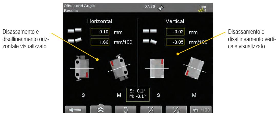
Disassamento e disallineamento orizzontale visualizzato
