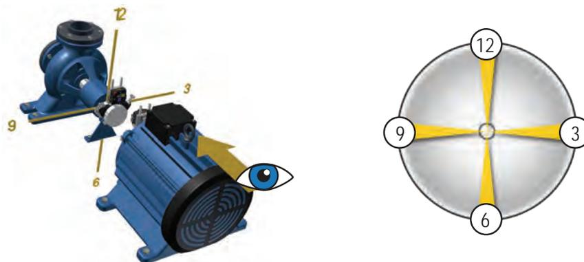
Mettere la macchina stazionaria (S) di fronte a quella mobile (M). La posizione a ore 9 si trova a sinistra, come nei programmi di misurazione.
