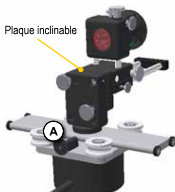
Image illustrant le prisme à proximité de la plaque inclinable.
