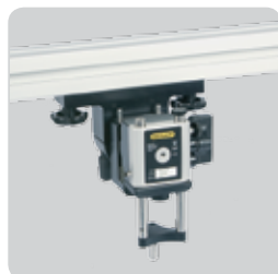
Montierter Detektor zum Empfang des Laserstrahls von der gegenüberliegenden Seite (rechts) aus. Auch mit Röhre möglich.
