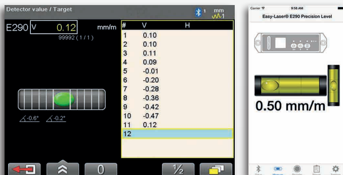
Digital och grafisk visning i Easy-Laser® avläsningsenhet och på iPhone.
