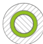
Smörjfilmen i ett normalt lager är mycket tunn. En dåligt riktad maskin, eller ett fundament som inte stödjer maskinen på korrekt sätt, ger upphov till ökat tryck och ökad värme i smörjfilmen. Detta leder i slutändan till att smörjmedlets egenskaper går förlorade, och maskinen havererar.
