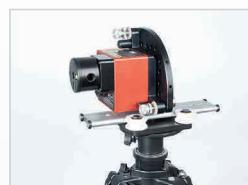
Лазер D22 установлен на штативе. Используется главным образом с системой E970.
