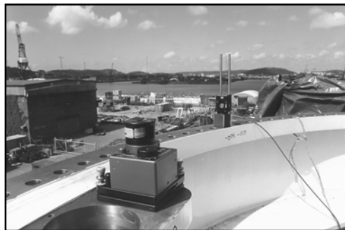
Ebenheitsmessung eines Laufrings an einem Schwenklager
