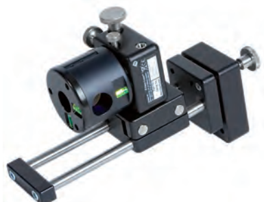
O prisma angular D46 é usado para medição de paralelismo dos flanges. Ele deflete o feixe de laser em 90°.
