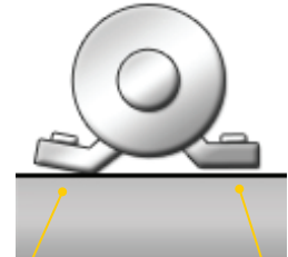
Kippfuß in Winkelposition Paralleler Kippfuß
