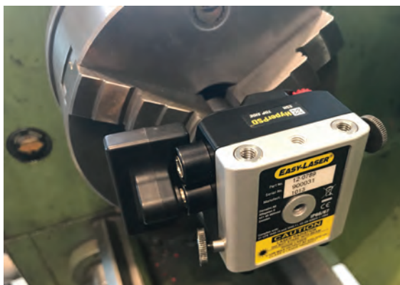
Unité S fixée sur le support d'axe.
