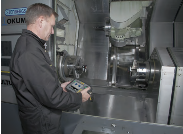
Equipement Easy-Laser® monté sur un tour avec tourelle.
