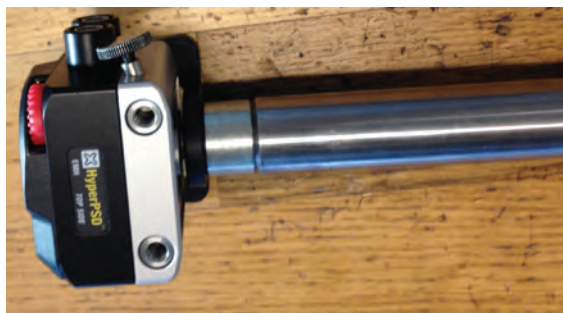
Unité M fixée sur le support pour barre (réf. 12-0988)
