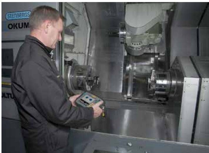
Easy-Laser®-utrustning monterad på en revolversvarv
