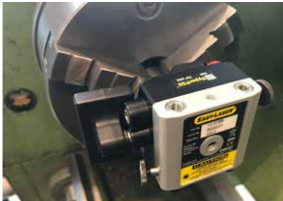
S-enhet monterad på spindelfästet
