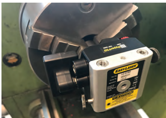
Unidad S montada en el soporte del husillo.
