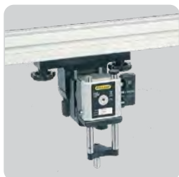
Détecteur monté pour recevoir le faisceau laser du côté opposé (droite). Également possible avec un tube.
