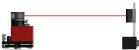
5–10 m mellan laser och detektor
