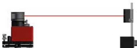
5-10 m entre o laser e o detector
