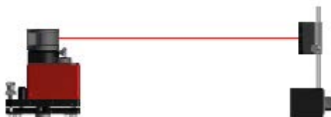
5-10 m entre o laser e o detector
