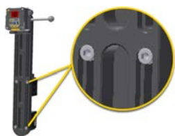
Ослабьте винты для регулировки кронштейна блока S
