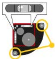
Livellare l'emettitore laser
