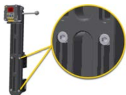
Odkręć pokrętła, aby wyregulować wspornik S.
