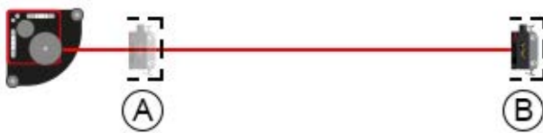
Wyzerowanie w pozycji A. Odczyt wartości w pozycji B.
