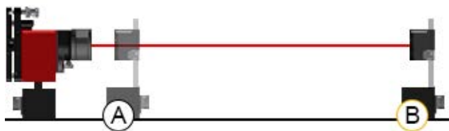
Montaż w pionie i osiowanie zgrubne w pozycji B.
