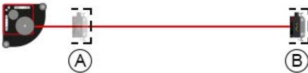
Auf Null setzen an Position A. Wert ablesen an Position B.
