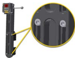
Lösen Sie die Schrauben zur Anpassung der S-Halterung.
