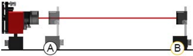
Vertikale Montage und Grobjustierung auf Position B.
