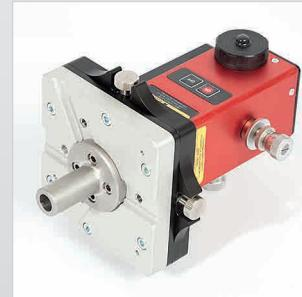
С помощью этого стержня можно установить отвод на шпиндель станка или подобную конструкцию. Палец полый. Номер по каталогу 12-1039
