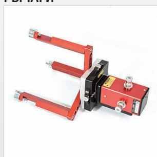
Позволяют производить измерения, когда детектор Linebore и излучатель находятся по одну сторону от отверстия. Номер по каталогу 12-0580
