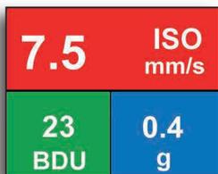
Отображение на виброметре. Текущие значения.
