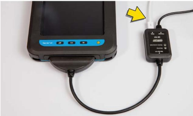
在没有网络的情况下, 可使用迷你 USB 电缆将测量值从 ECOM Tab-Ex 传输到您的计算机, 见上图。在资源管理器中读取: 本机 \Easy Laser (SM T360)\Tablet\Android\data\com.easylaser.xt\files\Measurements.
