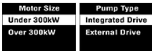
选择机器类型和尺寸后，可相应地设置 ISO 报警级别，操作与指定底座类型(刚性或柔性)相同。基本“原则”是，除非机器用螺栓旋紧在水泥地面上，否则应考虑使用柔性安装方式。大多数发动机和泵安装在某种机架或结构上，因此务必考虑采用柔性安装方式。
