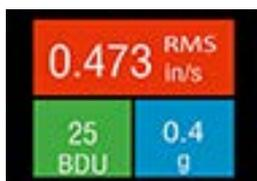
显示三个值。速度和 BDU 值用颜色编码以显示其报警状态。
