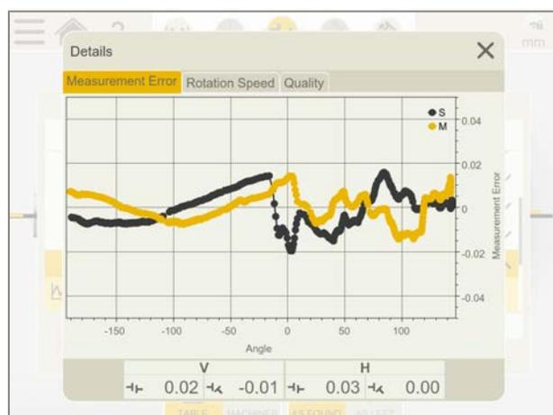
此图表显示的是各测量值相对于总体测量值的误差。误差标准偏差是质量指数“已达到的精确度”的基础。湍流、测量单元之间的距离及联轴器间隙都会影响测量误差。
