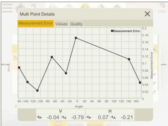
此图表显示的是各测量值相对于总体测量值的误差。各测量点的误差是指其与总体测量值的偏差。以偏移和角度显示。
