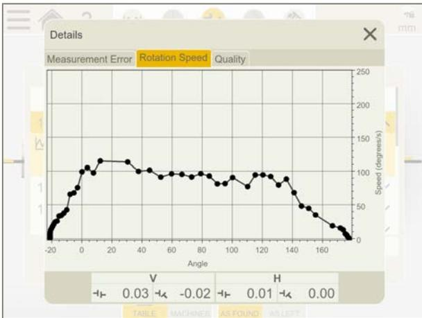
此图表显示的是测量期间测量单元的旋转速度。这是质量指数“速度和均匀度”的基础。
